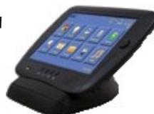
In **OmniPro II** è presente un'interfaccia vocale interattiva, con menù guidato, che agevola l'interazione con il sistema domotico in modo semplice, accedendovi da un apparecchio telefonico sia da remoto che connesso alla rete domestica. In caso di allarme o anomalia il sistema telefona fino a otto utenti ed invia un segnale digitale all'istituto di vigilanza privata.
